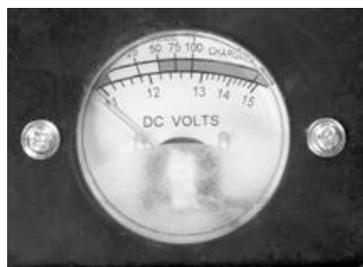
Prskalica je opremljena voltmetrom visoke preciznosti koji meri voltažu od 11V- 15V. Zelena zona obojene skale pokazuje da je baterija puna, što odgovara za normalnu upotrebu, žuta zona pokazuje nedovoljnu voltažu, ali sistem i dalje može da radi, crvena zona levo pokazuje ekstremno nisku snagu što zahteva trenutno punjenje.
