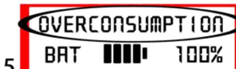
Ekran 5 – Ovo pokazuje OVERCONSUMPTION (PREKOMERNI UTROŠAK) u vidu poruke koja svetluca u liniji na vrhu ekrana. Prosečna snaga za zadnjih 1000 rezova je vrlo visoka u poređenju sa ukupnim prosekom rezanja. Status sečiva se mora uvek imati u vidu, kad se radi sa opremom, da bi se izbegli ozbiljni problemi.
